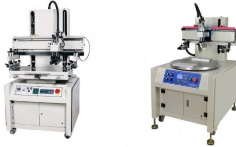
Resim 2.3 Düz Serigrafi Baskı Makinesi
