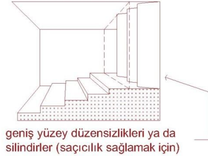
Şekil 2.21. Arka Duvar Ve Tavan Arasındaki Köşenin Pahlanması ve Saçıcılık Sağlamak Amaçlı Duvar Yüzeyine Farklı Çaplarda Silindirler Kaplanması
